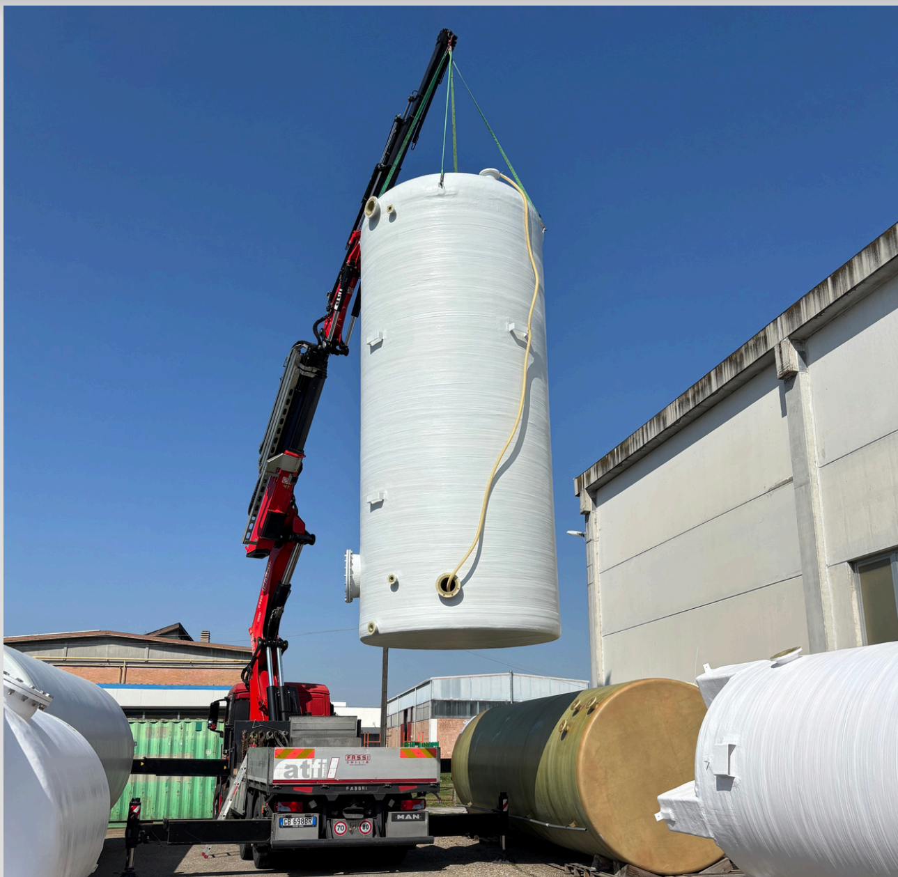
RIZZAGGIO SERBATOIO PER COLLAUDO IDROSTATICO
